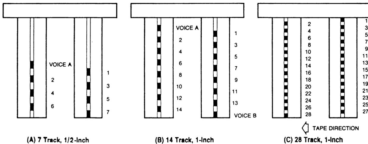
FIGURE 1-7. TYPICAL IRIG RECORD/REPRODUCE HEAD CONFIGURATIONS
