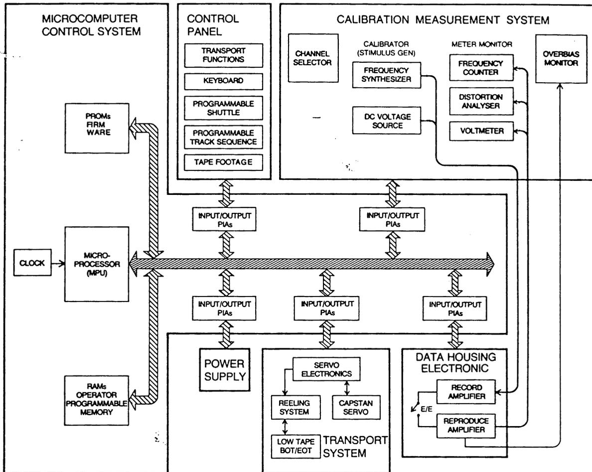
FIGURE 1-3. MODEL 101 SYSTEM BLOCK DIAGRAM
